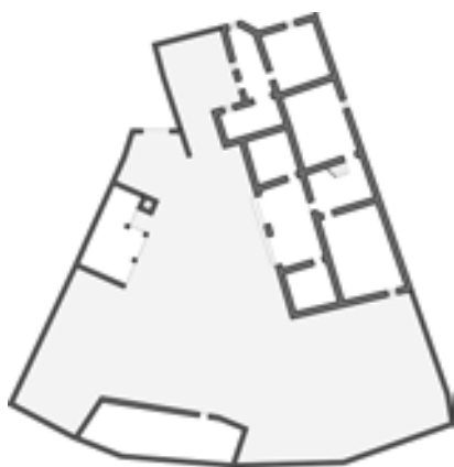
Fig. 2.28. Nereci, esempio di casa con corte antistante con accesso alla corte da portale.
